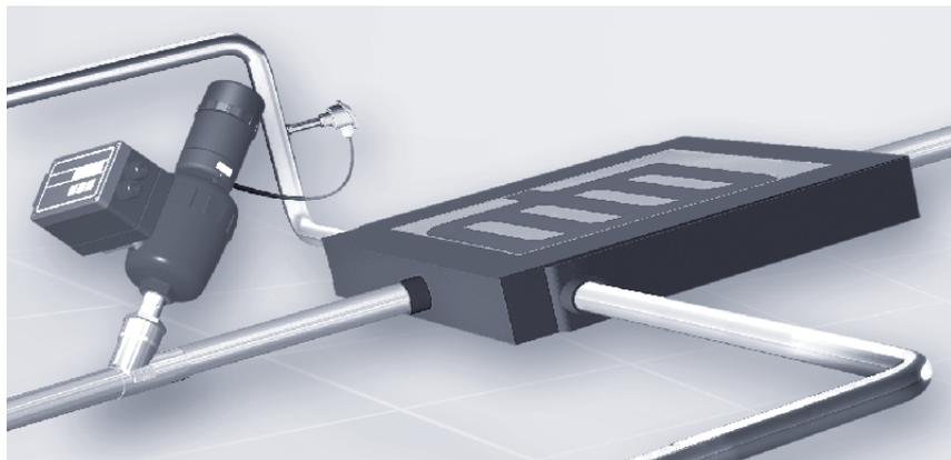
Регулирующий клапан типа 2702 с локальным ПИД-регулятором типа 1067. Клапан регулирует температуру среды на выходе из теплообменника. Сигнал на входе идет от простого преобразователя температуры.
